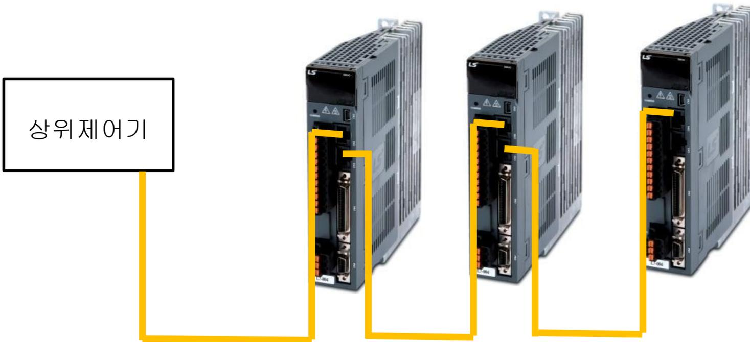
▶ PC를 상위제어기로 사용할 경우, 컴퓨터의 장치관리자에서 Serial Port 확인하고, 드라이브의 Baud Rate(P0-04), System ID(Node ID, P0-05)를 확인후 통신 프로그램에 입력하여야함.
